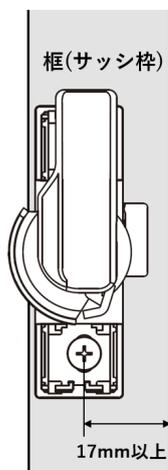
現在取付いているクレセントのねじ中心から室内方向に17mm以上の取付け面がないと部品がはみ出してしまい交換できない場合があります。
